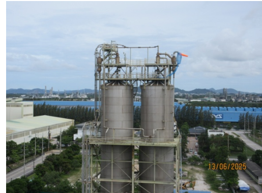
รูปที่ 3.2-6 Cyclone ชุดที่ 3 และ 4 (MC-1614 และ MC-1624)
